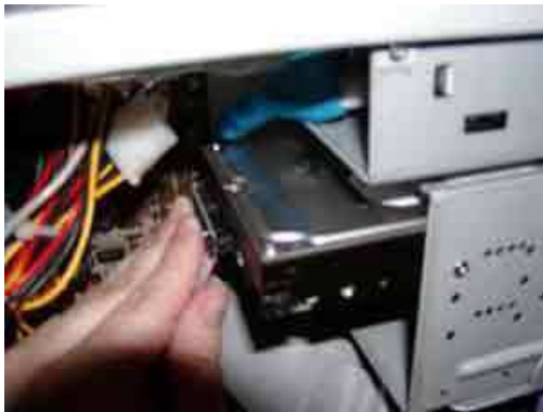
Pasang Kabel IDE Hard Drive pada hardware
