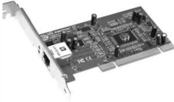
Gambar 1.9: Sebuah adapter jaringan Ethernet kabel yang dimasukkan ke dalam komputer desktop Anda.
