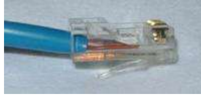
Gambar 8.4: Cara pasang salah, ujung kabel di dalam tidak menjangkau terminal (tidak tersambung)
