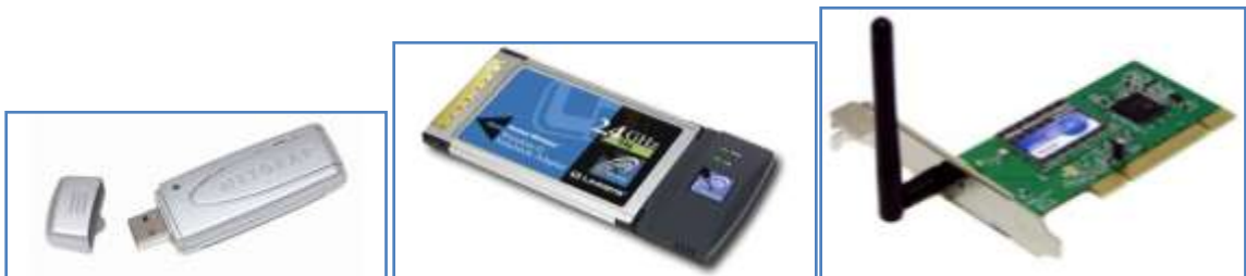
Gambar 2.10 : Contoh Wireless Network adapter dengan 3 cara pemasangan, gambar ketiga untuk PC.
